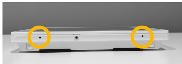
Der er placeret mikrofoner i bunden af panelet
